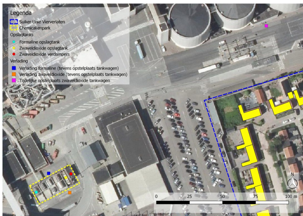
f5.3 Overzicht van het chemicaliënpark en de locatie van de tijdelijke stallingsplaats van de zwaveldioxide tankwagens
