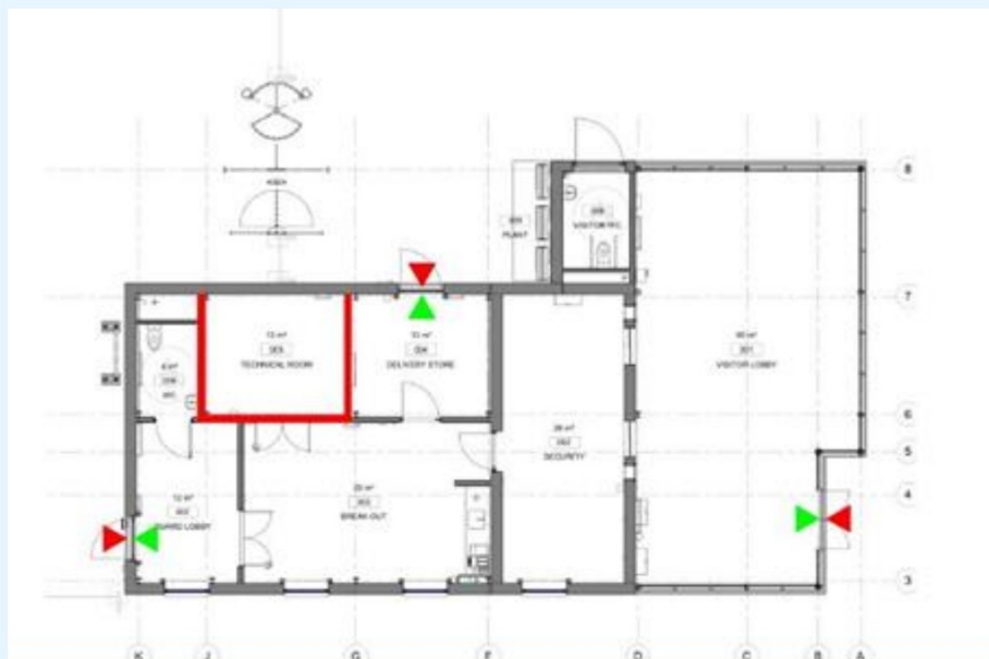
figuur 3: principe van brandcompartimenten
