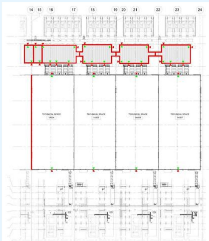
figuur 2: principe van brandcompartimenten
