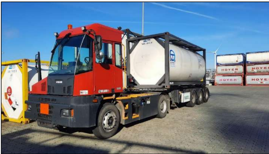
Afbeelding 4: terminaltruck Kalmar T2
